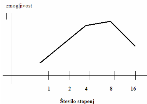
Slika 2: Odvisnost zmogljivosti CPE od stopnje cevovoda
