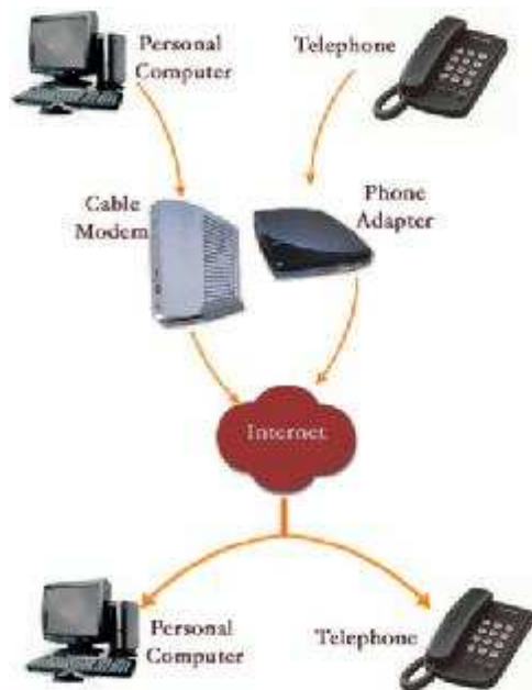
Slika 1: model VoIP-a prikazuje, kako lahko vzpostavimo komunikacijo z računalnikom ali telefonom preko interneta do drugega računalnika ali telefona
