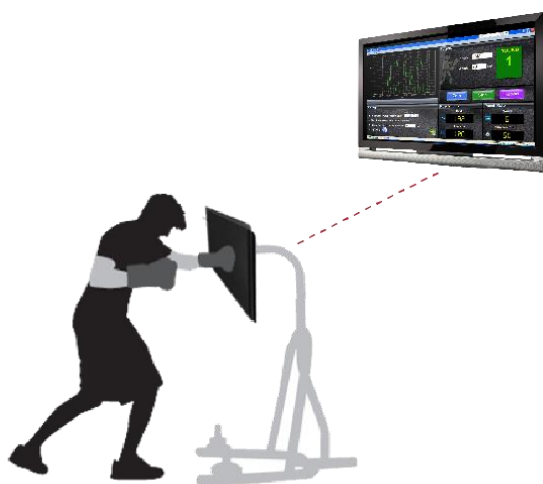
Slika 9: Naprava za merjenje udarcev pri boksu (vir: http://www.loadstarsensors.com/punch-force-measurement-boxer-training-boxing.html )
